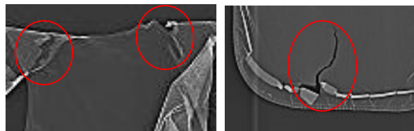
Fig.2 肩部の破損 Fig.3 たわみ部の破損
