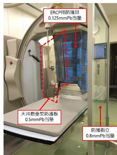
Fig. 1 測定配置図
